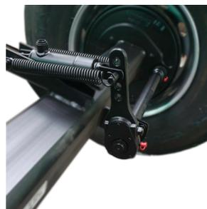
Bielas industriales regulables para ajuste de frenos por el desgaste por uso.
