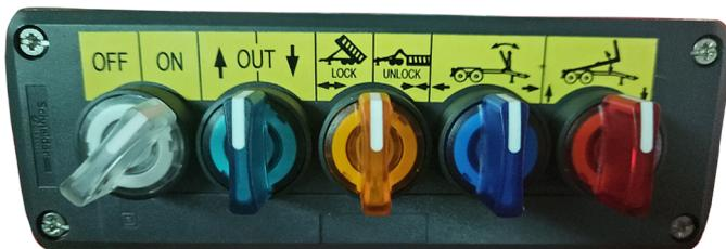
\*\*Sistema hidráulico centralizado controlado por botonera al tractor
